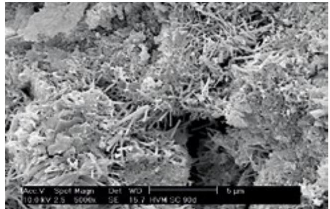
Vernadelung der Zementkristalle mit der Putzmatrix
