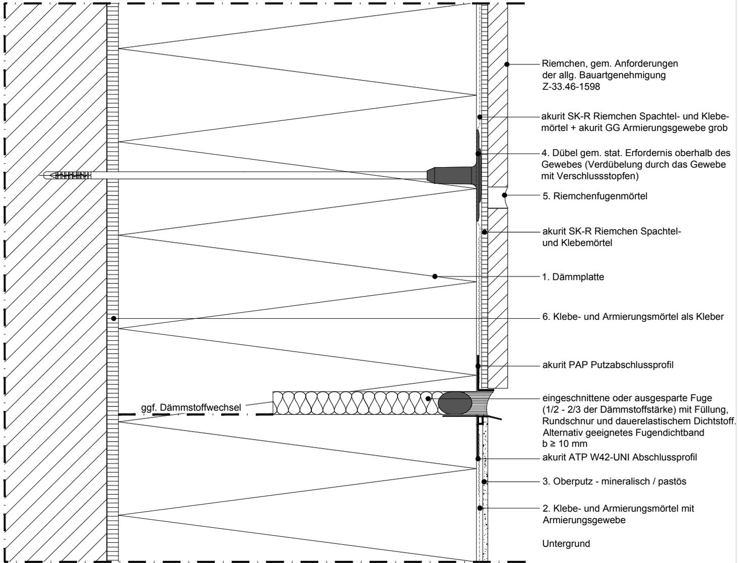
Darstellung eines akurit Wärmedämm- Verbundsystem. Angrenzende Gewerke sind nur schematisch dargestellt. Copyright: Sievert Baustoffe SE & Co. KG; Alle Rechte vorbehalten.
