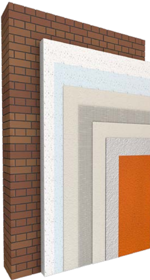
TRI-O-THERM im Gebäudebestand als Außendämmung auf Mauerwerk ► Siehe Kapitel 3.3
