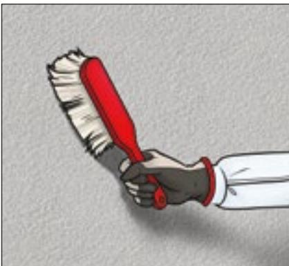
Bei Bedarf sind Staub und lose Teilchen von der Oberfläche abzusaugen oder abzukehren. Ist eine nicht ausreichend fest mit der Putzfläche verbundene Sinterhaut vorhanden, ist diese zu entfernen.
