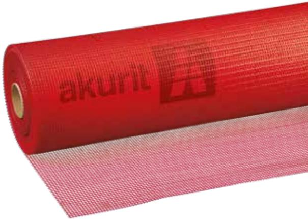
Das alkalibeständige Armierungsgewebe wird vollflächig in den oben beschriebenen **akurit SK leicht** Spachtel- und Klebemörtel eingebettet. Die Schichtdicke beträgt ca. 5 mm.
