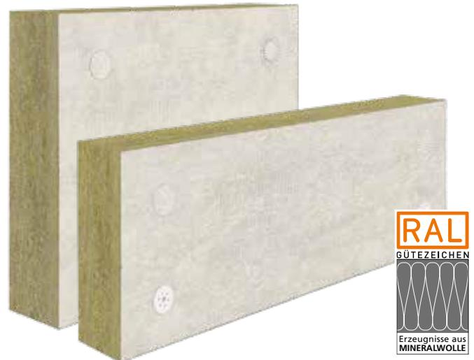
Als Dämmstoff kommen nichtbrennbare Mineralwolle-Putzträgerplatten des Typs akurit RP-MW-035-PT-B zum Einsatz. Die hoch verdichtete Oberlage sorgt für eine hervorragende Putzhaftung des Armierungsmörtels und für eine sichere Verdübelung. Die beidseitige Beschichtung ermöglicht die maschinelle Verarbeitung des Klebe- und Armierungsmörtels ohne vorherige Pressspachtelung auf dem Dämmstoff und sorgt für eine hervorragende Putzhaftung.
