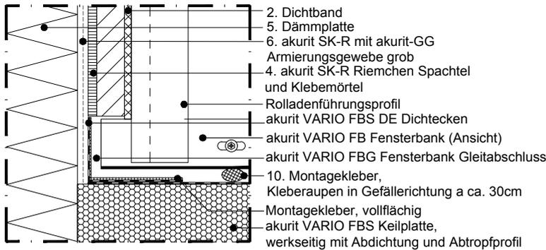
Vertikalschnitt unterer Fensteranschluss
