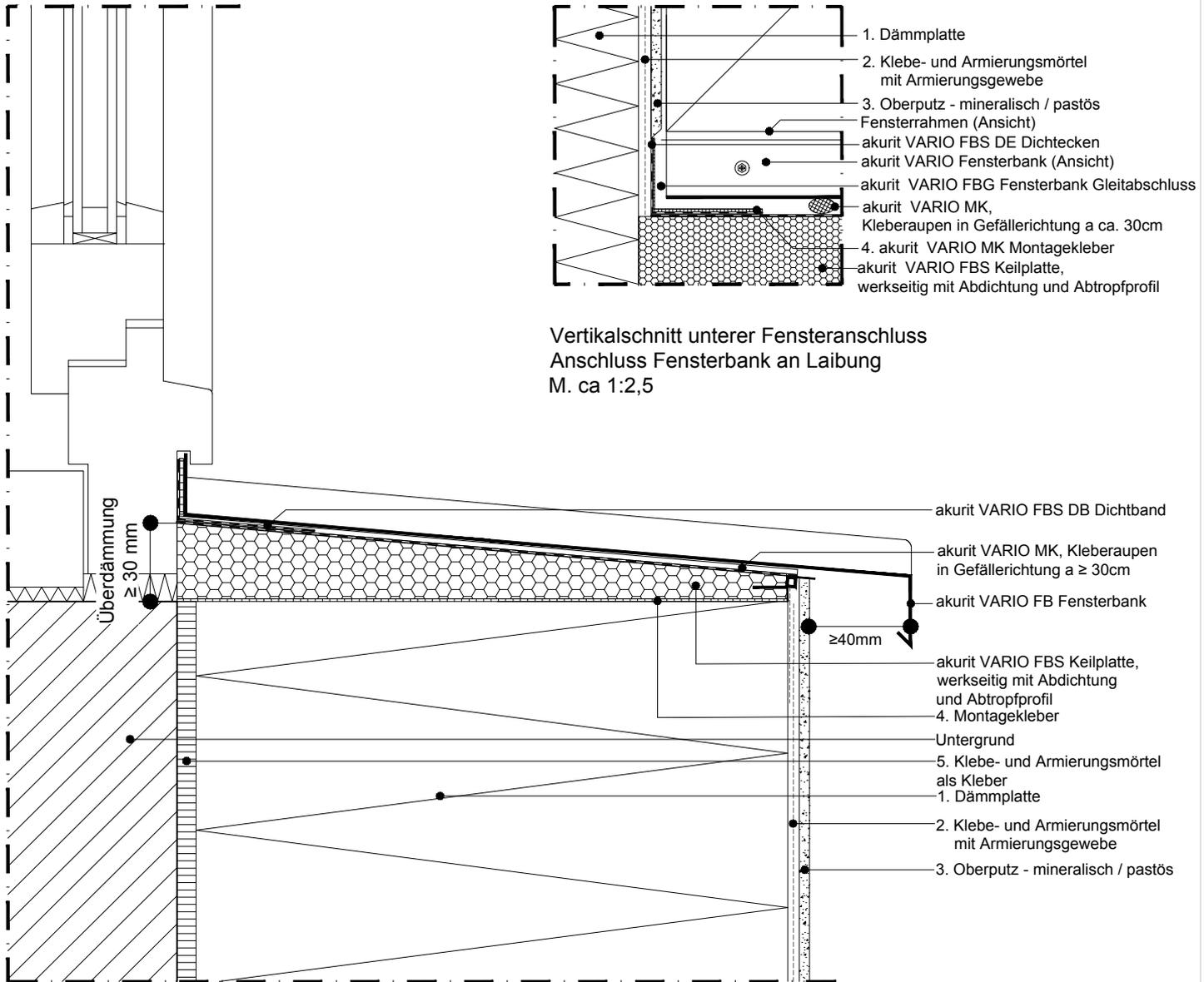
Vertikalschnitt unterer Fensteranschluss
