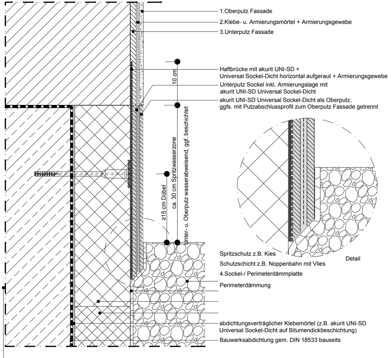
Darstellung eines akurit Wärmedämm- Verbundsystems. Anrenzende Gewerke sind nur schematisch dargestellt. Copyright: Sievert Baustoffe SE & Co. KG. Alle Rechte vorbehalten.
