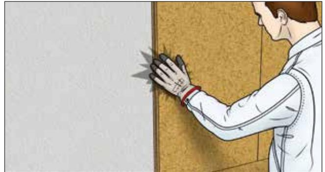
**2** Die Innendämmplatten müssen vollflächig im Floating-Buttering-Verfahren mit dem Mauerwerk verklebt werden. Die Feder der Platte weist nach oben. Durch Einschwimmen der Dämmplatte wird die Vernetzung mit dem Untergrund verstärkt. Wenn möglich, sollten im Innenbereich Dämmplatten ohne Nut und Feder verarbeitet werden. Dann lassen die Platten sich leichter ausrichten und es besteht auch nicht die Gefahr, dass sich Kleberreste hinter der Feder festsetzen.
