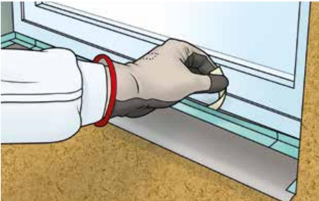
**7** Die Schutzfolien des AKURIT WF Multi-Tape-F ST werden entfernt und die seitlichen Klebebänder mit der hochragenden STEICOMulti UDB verklebt. Diese Ausführung leitet Wasser, das trotz Vorkehrungen unter die Fensterbank gelangt, nach vorn ab.
