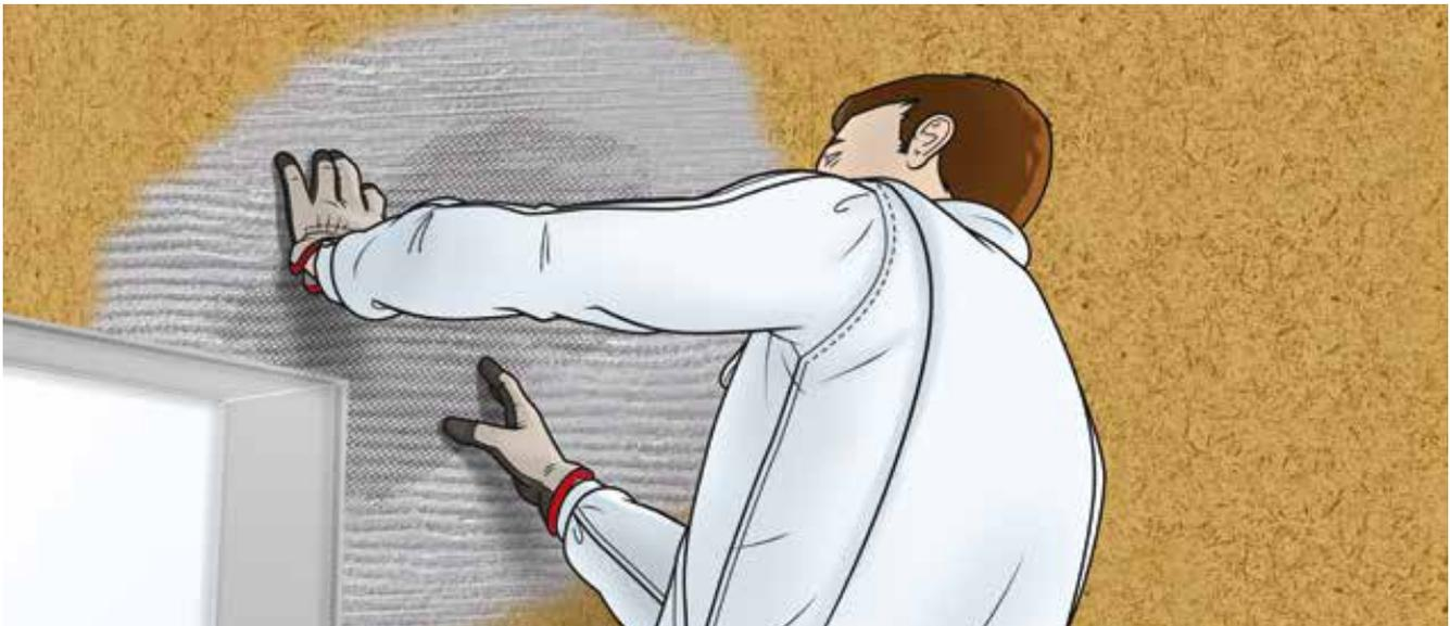
**1** Zusatzarmierungen wie Diagonalarmierungen, Eckprofile, Fensteranschlussprofile sind in diese Lage einzulegen.
