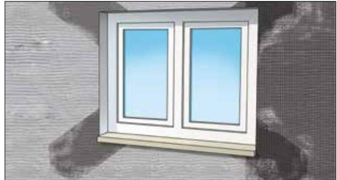
**2** An allen Gebäudeöffnungen sind zusätzliche Diagonalarmierungen einzulegen, bestehend aus AKURIT GEP Gewebepfeil oder Gewebestreifen mit ca. 30 × 30 cm. Die Diagonalarmierung ist auch in die Innenecken von Sturz und Laibung einzubringen.
