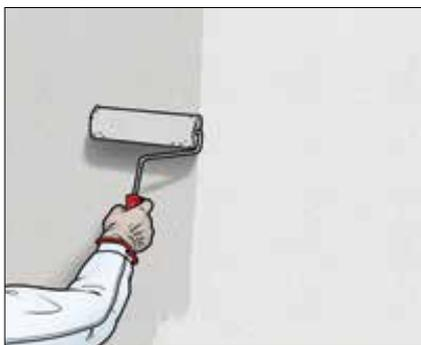
**1** Mit Quast oder Lammfellroller wird AKURIT GTA Acrylat-Tiefengrund auf die Wand aufgetragen und nach der Trocknung als Haftgrund der AKURIT GMG Mineralgrund.
