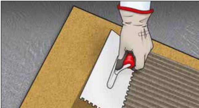
**1** Die Kleberschicht des AKURIT KSN KALKSPACHTEL NATUR wird auf die Rückseite der Platte mittels 10er-Zahntraufel vollflächig aufgetragen. Anschließend wird auf dem Bestandsmauerwerk ebenfalls eine Kleberschicht AKURIT KSN KALKSPACHTEL NATUR mit der Zahntraufel aufgetragen.
